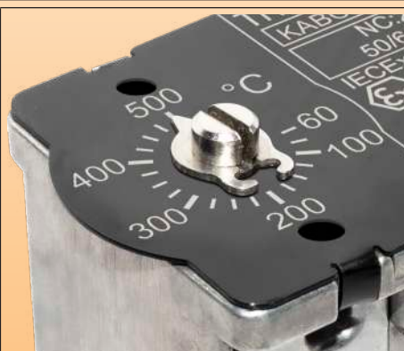
C : Réglage par tournevis et clips flèche, sur cadran aluminium imprimé, pour utilisation dans les boîtiers EX-e en PPS de JPCI ou d'autres fournisseurs en traçage électrique ;
